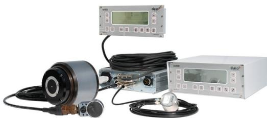
ELASO eb4500既能实现砂轮自动平衡也能手动平衡，控制单元既可以控制装到主轴端的外置平衡头也可以控制安装到主轴中心孔内的内置平衡头，砂轮的振动值由一个振动传感器采集并且传输到该单元上显示，信号接收器连接电子信号到旋转的平衡头，可以是电刷滑环类型或者是
