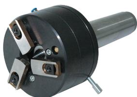
工件定心自动夹具在磨削过程中，能够高效、可靠的驱动夹具和（活动或固定）顶尖之间的工件，全自动装卸磨料，工件夹具为弹簧锁紧，气压释放。该产品严格依照莫式锥度设计的安装单元，可装配到大部分磨床中使用。在磨削过程中，工件夹具根据工件的形状自动锁定工件，保障了工人的安全，工件定心自动夹具运行平稳、准确，能够提升被加工件的精度和品质。AG3/40是一个扩展产品，能够在花键末端或主轴端牢牢抓紧工件。工件定心自动夹具的型号有AG3, AG6。
