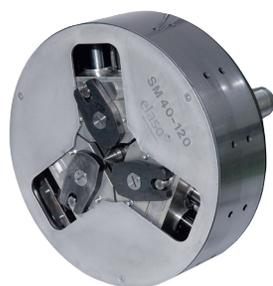
工件定心大规格自动夹具SM40-120应用在莫式锥度为#5或#6的大型磨床中。全自动装卸工件直径范围为40mm (1.6") -120mm (4.7")，工件夹具为气压夹紧和滑动锁。工件夹具自动锁定工件的原理是根据在磨削工件时产生的扭矩自动调整压力，工件夹具直径长为400mm (15.75")-250mm (10")。
