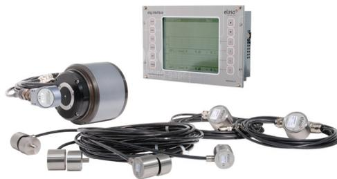
ebg1500可显示磨削时间相关的声发射信号，可达到磨削过程优化，通过界面可以调整AE的放大增益参数；ebg1500灵敏度更高，更能识别出工件和砂轮或砂轮和修整工具的接触，仅仅需要几个 $\mu\text{m}$ 的进给量，显著地减少了空程时间，提高了生产效率、节约了生产成本。可存储8组数据，更易于需要重复加工部件快速切换获得适合的参数。
